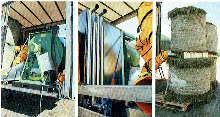
Auf der mobilen Trocknung von Burdorf sind ein Gebläse und ein Wärmetauscher installiert.
