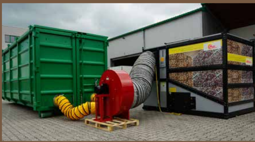
Die Containertrocknung ist ebenfalls mit Kiemensblechen ausgestattet und wird von einem LandrTherm Hackgutofen LA 250 beheizt.
